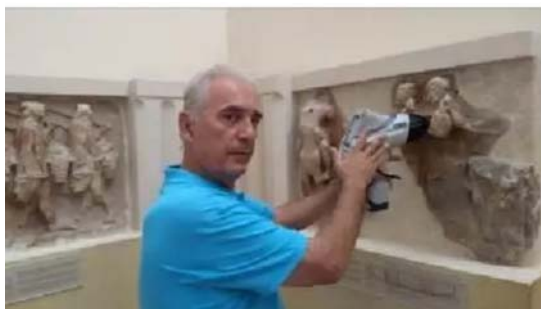
Ιωάννης Λυριντζής εν ώρα εργασίας: Μετρήσεις XRF ανάγλυφης διχαλωτής μετόπης του Σικωνικού θησαυρού Μουσείου Δελφών.
